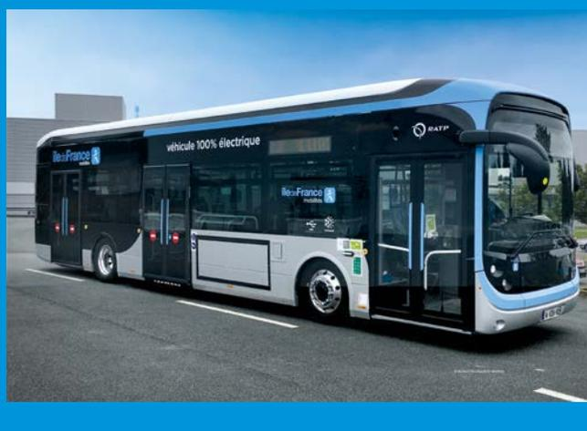
Bluebus 12 mètres équipé de six batteries LMP® lui permettant d'assurer jusqu'à 320 kilomètres d'autonomie. Partenaire de la RATP depuis 2014, Bluebus a remporté en 2021 un second appel d'offres pour une livraison de bus en 2023.
